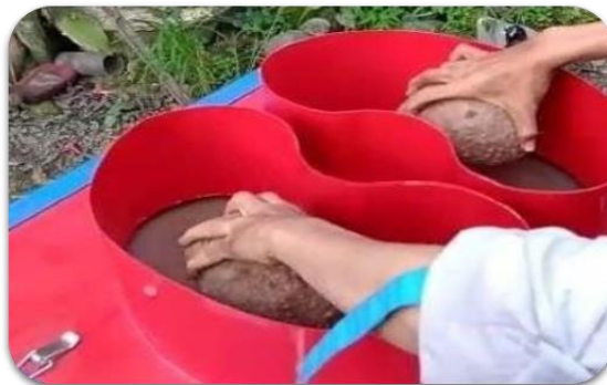
Gambar 6. Hopper input tempat masuknya umbi porang
