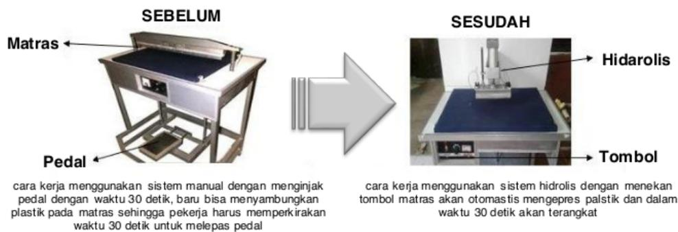
**Gambar 2.** Peningkatan mesin press manual menjadi hidrolis
