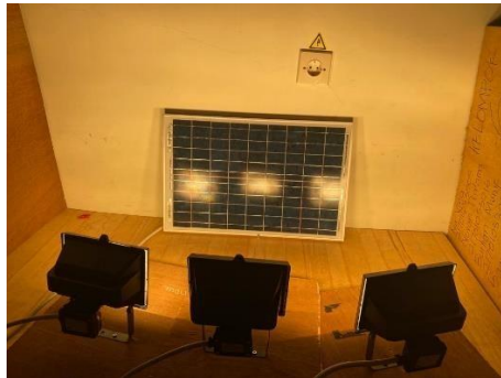
Gambar 4. PV dengan Menggunakan Sumber Lampu Halogen
