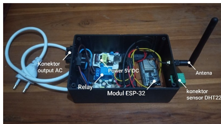
Gambar 8 Rangkaian Sistem Monitoring dan Kontrol Suhu
