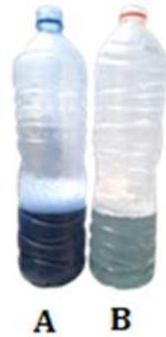
**Gambar 4.** Hasil Limbah Cair Batik (a) Limbah Cair batik sebelum mendapatkan tindakan pengolahan dengan sistem presipitasi dan filtrasi; (b) Limbah Cair batik setelah mendapatkan tindakan pengolahan dengan sistem presipitasi dan filtrasi
