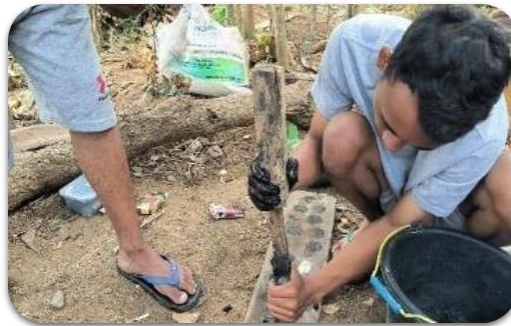
Gambar 3. Proses pencetakan briket dan penjemuran briket ampas tebu
