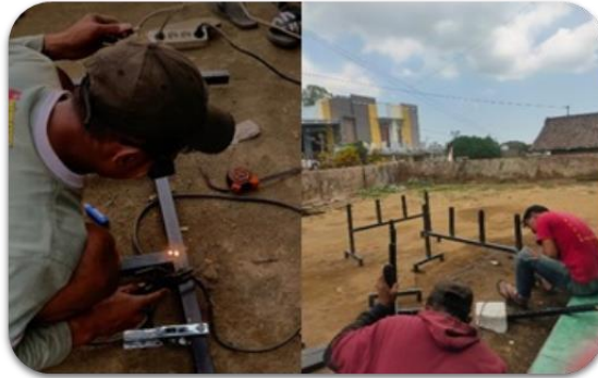
Gambar 1. Pemotongan besi dan penyambungan untuk rangka
