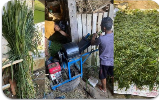
Gambar 2. Rumpuk pakchong segar dan proses pemotongan rumpuk pakchong menggunakan chopper
