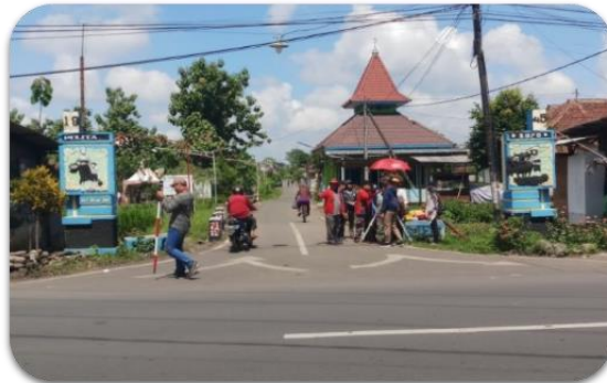
Gambar 6. Penggunaan total station untuk menentukan batas lahan dan titik koordinat tapak
