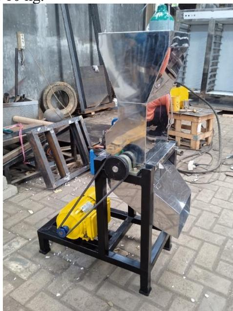
**Gambar 3.** Foto mesin penyuir daging ikan tongkol kapasitas 10 kg
