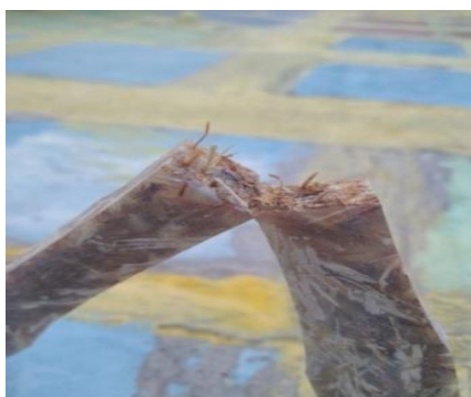
Gambar 4. Hasil uji impact fraksi volume 30 : 70 dengan orientasi continuous horizontal
