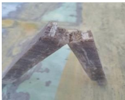
Gambar 3. Hasil uji impact fraksi volume 50 : 50 dengan orientasi continuous vertical
