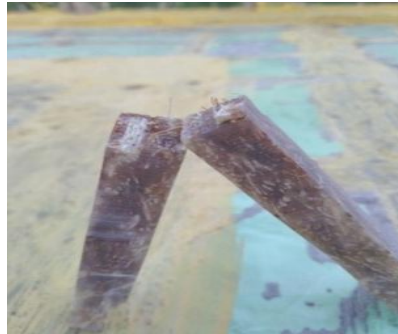
Gambar 5. Hasil uji impact orientasi acak fraksi volume 30 : 70
