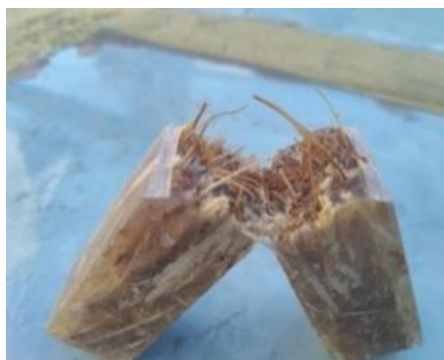
Gambar 1. Hasil uji impact fraksi volume 50 : 50 dengan orientasi continuous horizontal
