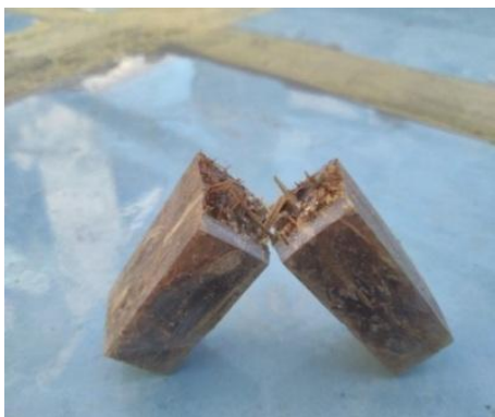
Gambar 2. Hasil uji impact fraksi volume 50 : 50 dengan orientasi acak
