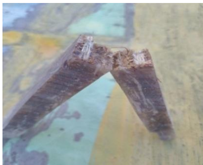
Gambar 6. Hasil uji impact orientasi vertical fraksi volume 30 : 70
