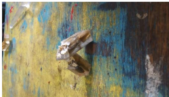
Gambar 6. foto hasil uji impact fraksi volume 50:50 dengan konsentrasi 10%
