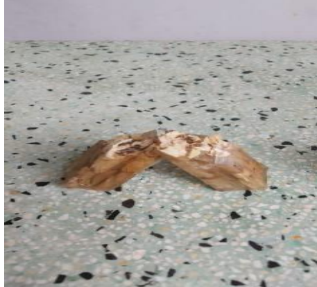
Gambar 3. Foto hasil uji impact fraksi volume 50:50 dengan konsentrasi 5%
