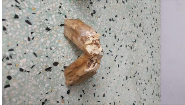
Gambar 7. Foto hasil uji impact fraksi volume 60:40 dengan konsentrasi 10%
