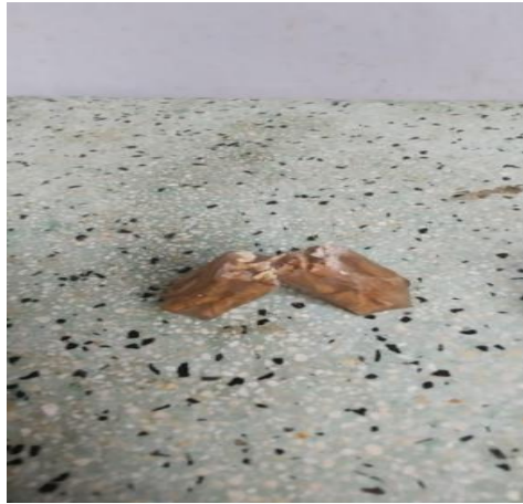
Gambar 5. foto hasil uji impact fraksi volume 40:60 dengan konsentrasi 5%
