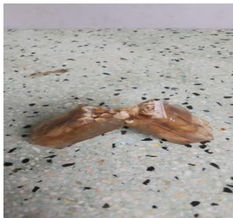
Gambar 2. foto hasil uji impact fraksi volume 40 : 60 dengan konsentrasi 10%
