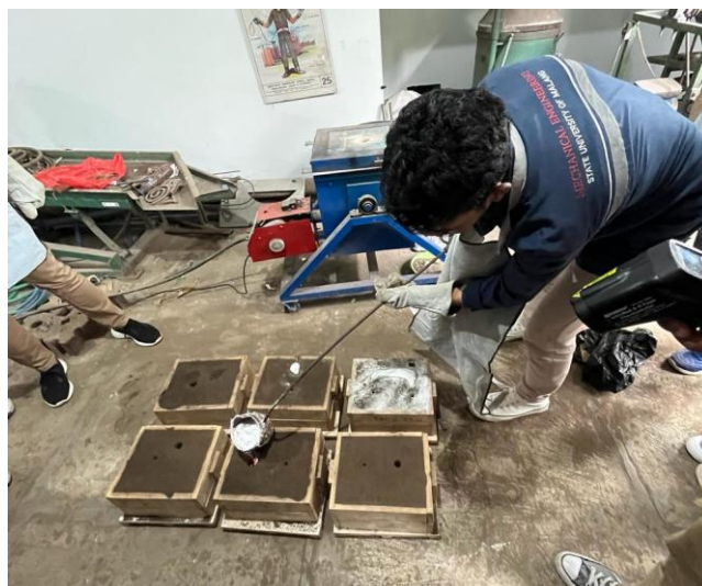
Gambar 3. Proses Pengecoran dengan Variasi Komposisi Pasir Cetak
