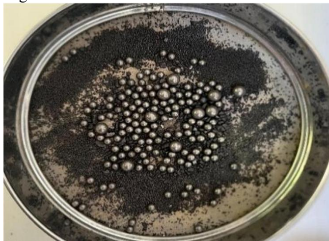
Gambar 2. Proses Pemisahan Serbuk Karbon dengan Zirconia Ball.
