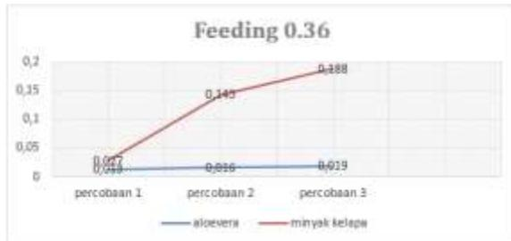
Grafik Nilai keausan pahat dengan Kecepatan *Spindel* 835 rpm dan pada feeding 0,36 mm/put dengan *cutting fluid* aloe vera dan dan *cutting fluid* minyak kelapa.
