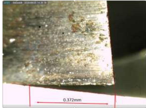
Berdasarkan Gambar diatas pada proses pembubutan dengan *cutting fluid* minyak kelapa kecepatan putaran *spindel*: 835 rpm, gerak pemakanan 0,36 mm, kedalaman makan antara 1mm. didapatkan nilai keausan pahat terendah sebesar 0.027 mm
