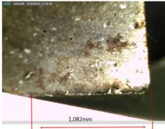
Berdasarkan Gambar diatas pada proses pembubutan dengan *cutting fluid* aloe vera kecepatan putaran *spindel*: 835 rpm, gerak pemakanan 0,42 mm, kedalaman makan antara 1mm. didapatkan nilai keausan pahat tertinggi sebesar 0.372 mm
