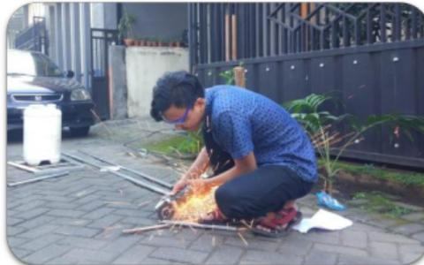
**Gambar 6.** Proses pemotongan besi galvanis
