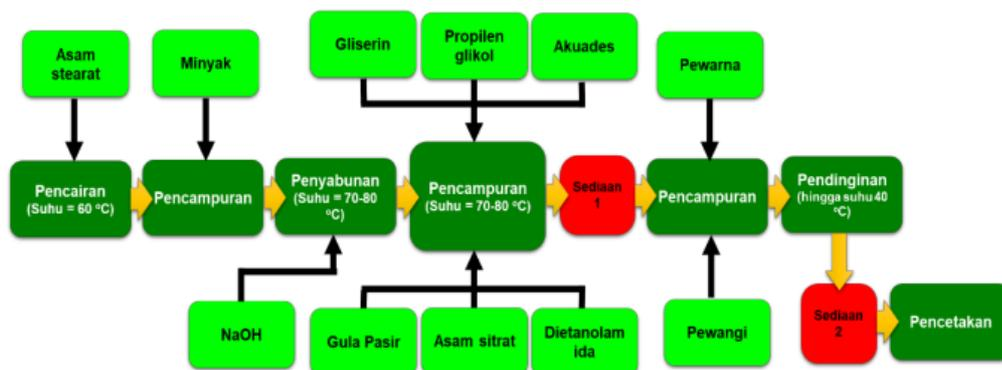
Gambar 3. Tahapan proses pembuatan sabun transparan
