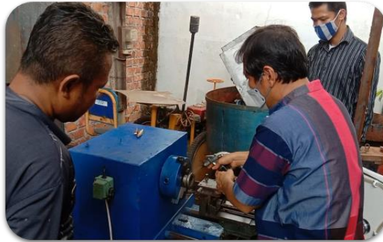
Gambar 6. Pelaksanaan demo cara penggunaan alat MQL pada mesin bubut
