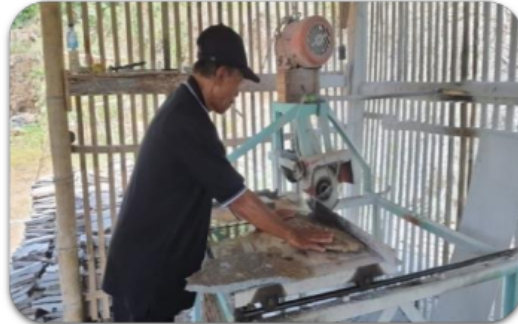
Gambar 9. Proses pemotongan batu piring dengan alat pemotong
