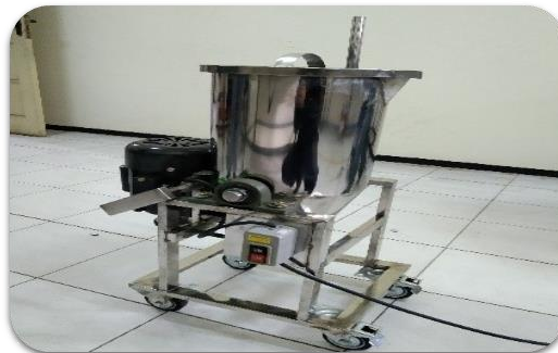
Gambar 5. Mesin blender portabel dari bahan stainless steel dengan 4 roda
