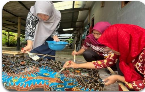
Gambar 9. Proses pemberian indigosol untuk mengunci pewarnaan batik
