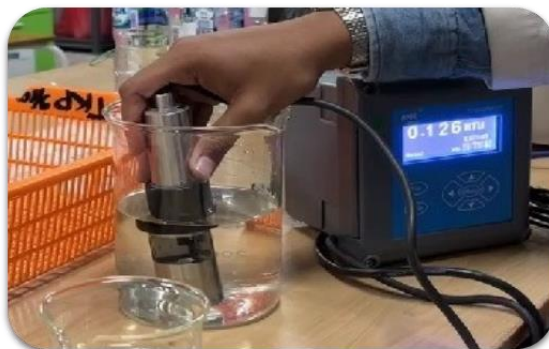
Gambar 6. Pengujian nilai kekeruhan setelah dilakukan filtrasi air
