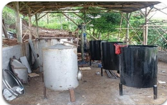
Gambar 6. Setting alat penyulingan minyak atsiri model HH1 di rumah produksi
