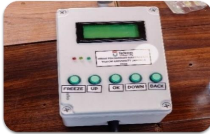
Gambar 1. Tampilan timbangan pintar berbasis IoT
